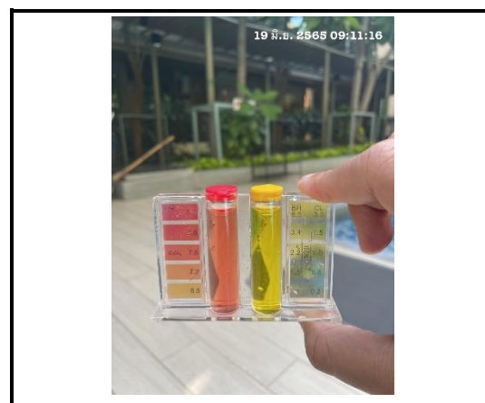
รูปที่ 3.24 ตรวจสอบความเป็นกรดต่าง ของสระว่ายน้ำเป็นประจำ
